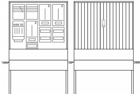
Zähleranschlussssäule für den Außenbereich mit Regendach,
