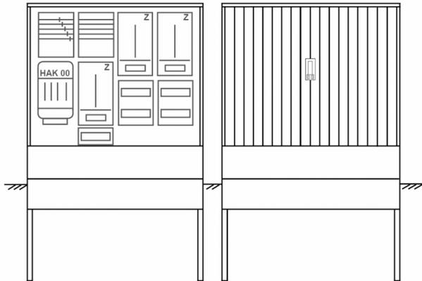
Zähleranschlussssäule für den Außenbereich mit Regendach,
