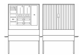
Zähleranschlusssäule für den Außenbereich mit Regendach,
