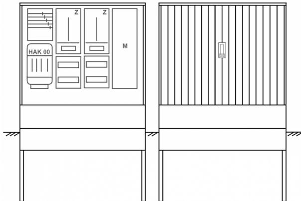
Zähleranschluss säule für den Außenbereich mit Regendach,
