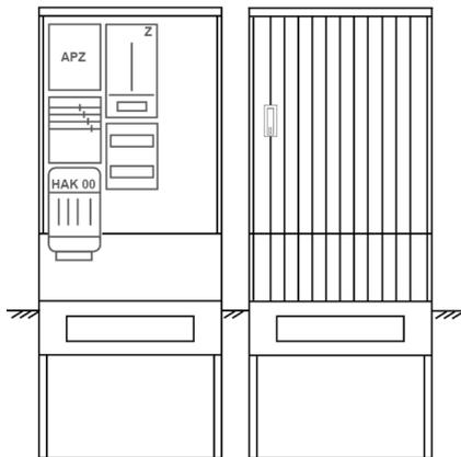
Zähleranschlussssäule für den Außenbereich mit Regendach,
