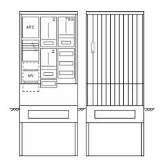
Zähleranschlusssäule für den Außenbereich mit Regendach,
