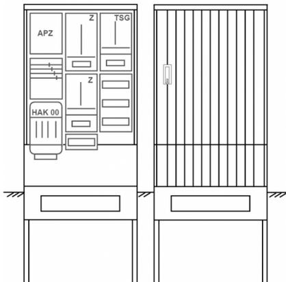
Zähleranschlussssäule für den Außenbereich mit Regendach,
