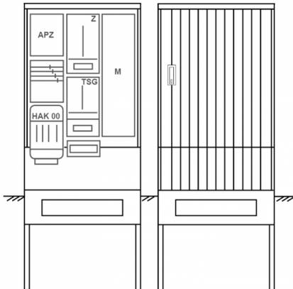
Zähleranschluss säule für den Außenbereich mit Regendach,
