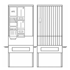
Zähleranschlusssäule für den Außenbereich mit Regendach,
