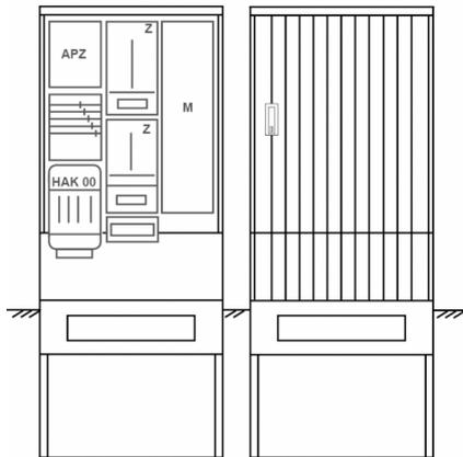
Zähleranschlussssäule für den Außenbereich mit Regendach,
