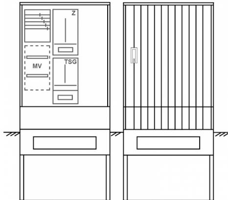
Zähleranschlussssäule für den Außenbereich mit Regendach,
