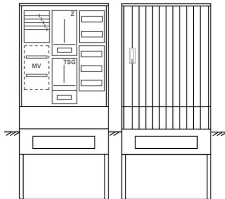
Zähleranschlussssäule für den Außenbereich mit Regendach,
