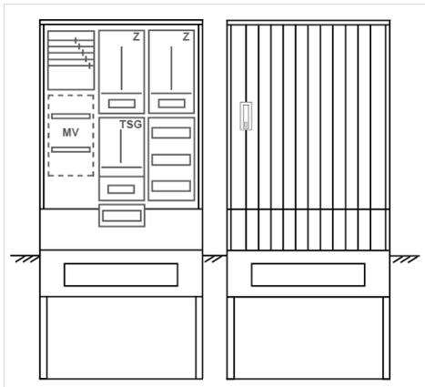
Zähleranschlussssäule für den Außenbereich mit Regendach,
