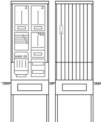
Zähleranschlussssäule für den Außenbereich mit Regendach,
