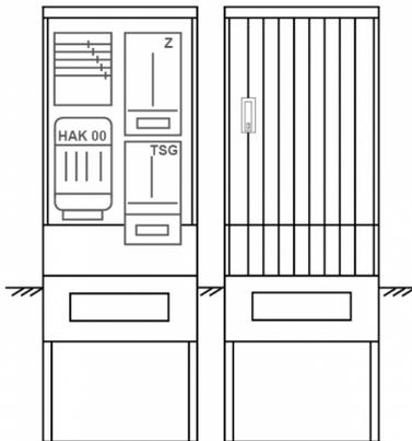
Zähleranschlussssäule für den Außenbereich mit Regendach,
