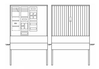
Zähleranschlusssäule für den Außenbereich mit Regendach,
