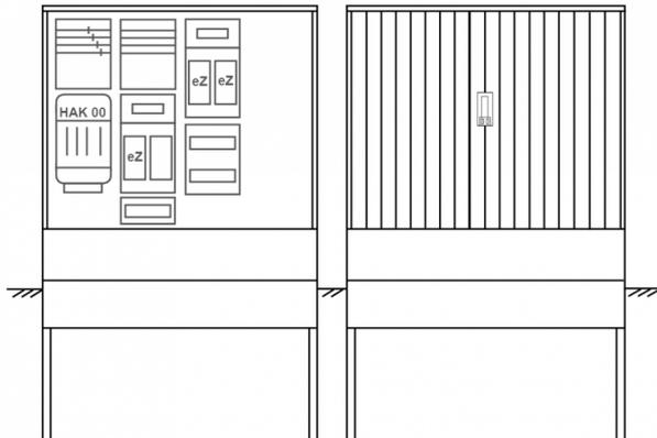
Zähleranschlussssäule für den Außenbereich mit Regendach,
