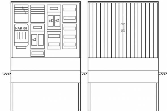
Zähleranschlussssäule für den Außenbereich mit Regendach,
