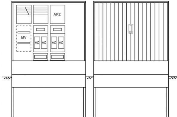
Zähleranschlussssäule für den Außenbereich mit Regendach,
