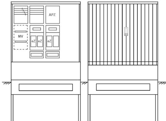
Zähleranschlussssäule für den Außenbereich mit Regendach,
