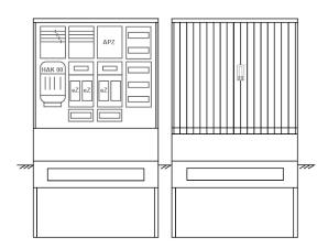
Zähleranschlusssäule für den Außenbereich mit Regendach,
