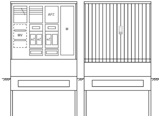
Zähleranschlussssäule für den Außenbereich mit Regendach,
