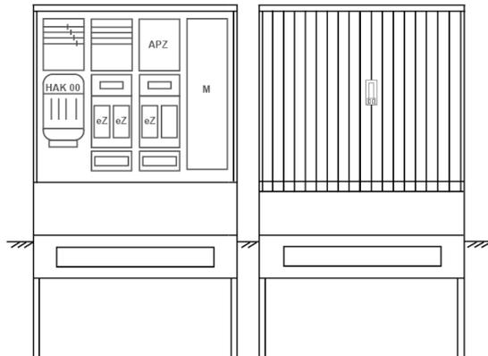
Zähleranschlussssäule für den Außenbereich mit Regendach,
