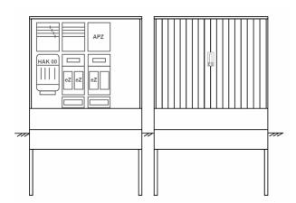
Zähleranschlusssäule für den Außenbereich mit Regendach,
