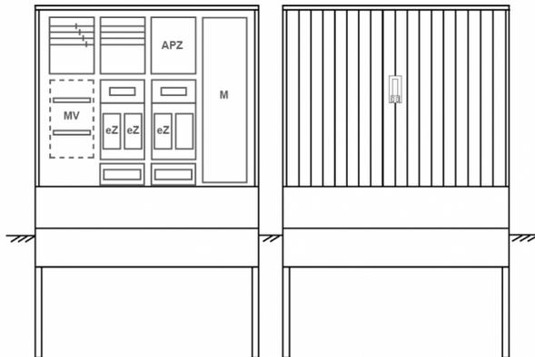
Zähleranschlussssäule für den Außenbereich mit Regendach,
