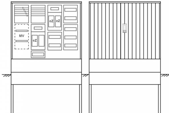
Zähleranschlussssäule für den Außenbereich mit Regendach,
