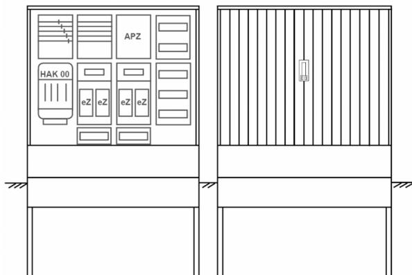
Zähleranschluss säule für den Außenbereich mit Regendach,
