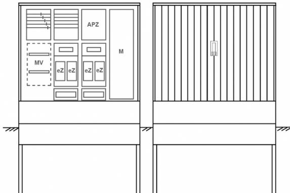
Zähleranschlussssäule für den Außenbereich mit Regendach,
