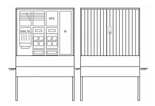
Zähleranschlusssäule für den Außenbereich mit Regendach,
