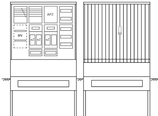
Zähleranschlussssäule für den Außenbereich mit Regendach,
