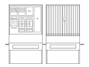
Zähleranschlusssäule für den Außenbereich mit Regendach,
