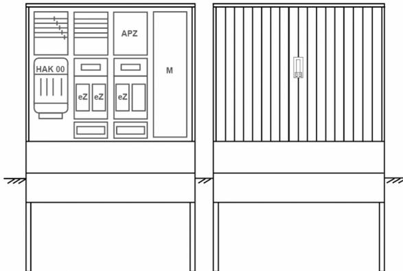
Zähleranschluss säule für den Außenbereich mit Regendach,
