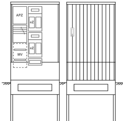
Zähleranschlussssäule für den Außenbereich mit Regendach,
