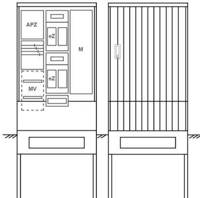
Zähleranschlussssäule für den Außenbereich mit Regendach,
