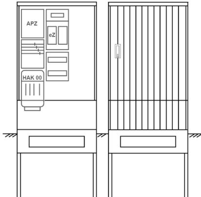
Zähleranschlussssäule für den Außenbereich mit Regendach,
