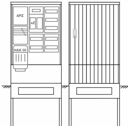
Zähleranschlussssäule für den Außenbereich mit Regendach,
