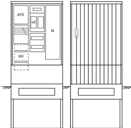
Zähleranschlussssäule für den Außenbereich mit Regendach,
