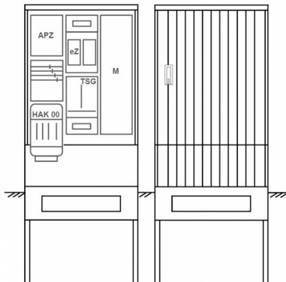
Zähleranschluss säule für den Außenbereich mit Regendach,
