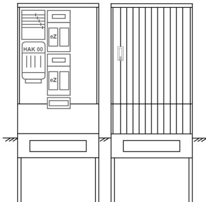
Zähleranschluss säule für den Außenbereich mit Regendach,
