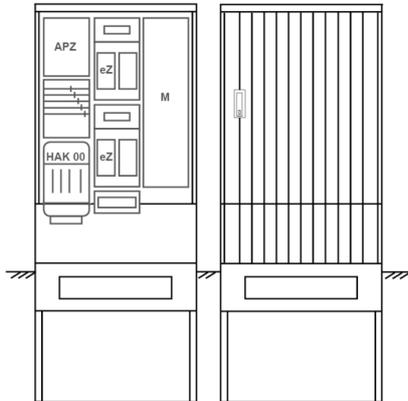
Zähleranschlussssäule für den Außenbereich mit Regendach,
