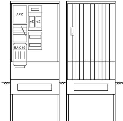
Zähleranschluss säule für den Außenbereich mit Regendach,
