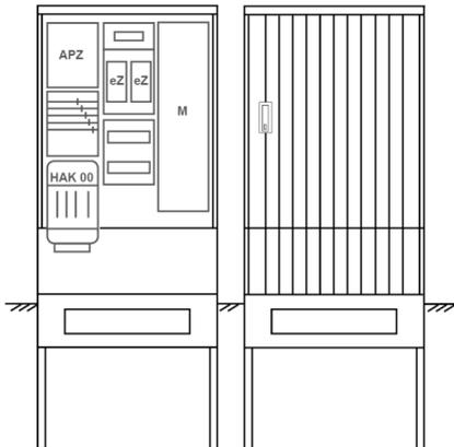
Zähleranschlussssäule für den Außenbereich mit Regendach,
