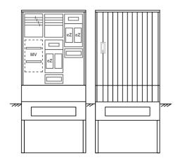
Zähleranschlusssäule für den Außenbereich mit Regendach,
