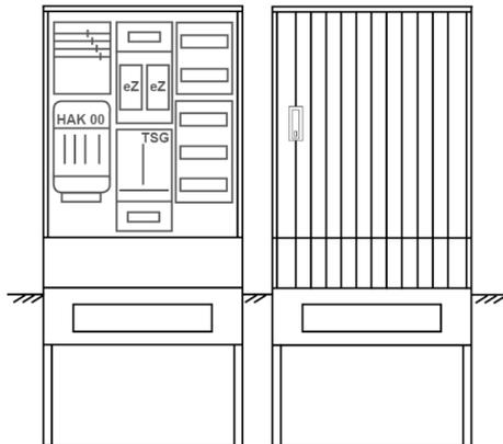
Zähleranschlussssäule für den Außenbereich mit Regendach,
