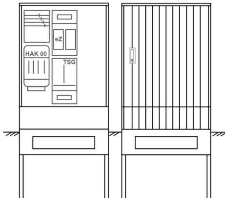
Zähleranschlussssäule für den Außenbereich mit Regendach,
