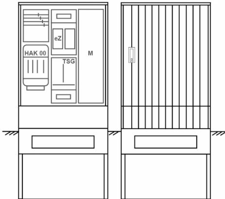
Zähleranschlussssäule für den Außenbereich mit Regendach,
