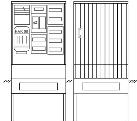
Zähleranschlussssäule für den Außenbereich mit Regendach,
