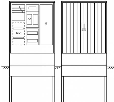
Zähleranschlussssäule für den Außenbereich mit Regendach,
