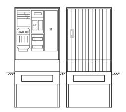
Zähleranschlusssäule für den Außenbereich mit Regendach,
