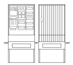
Zähleranschlusssäule für den Außenbereich mit Regendach,
